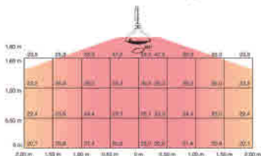
Área de calentamiento - Heating area
